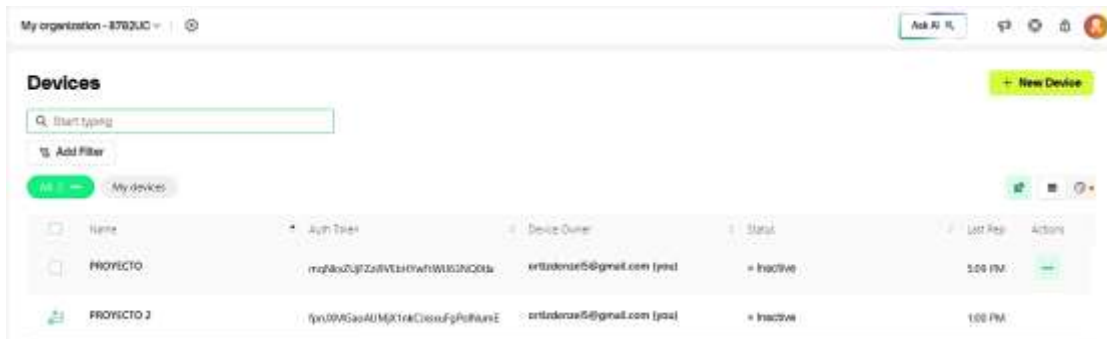
Figura 33. Generación de token dentro de la plataforma Blynk.
