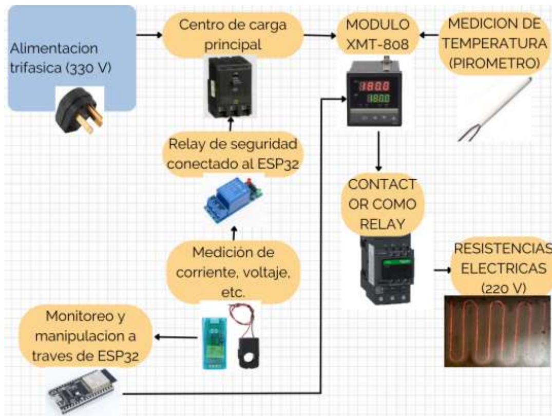
Figura 39. Diagrama de bloques-esquemático del sistema de control.
