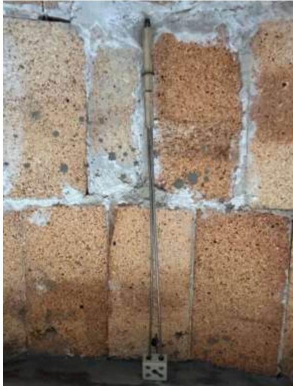
Figura 21. Fijación del Termopar dentro del horno.
