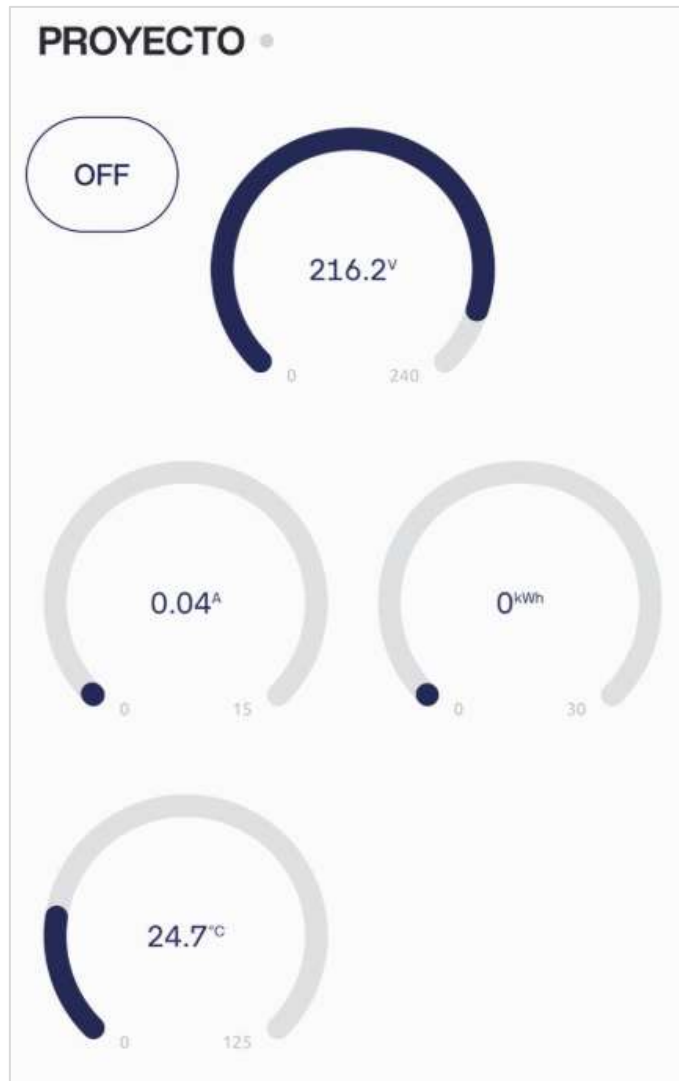
Figura 44. Interfaz de la aplicación móvil de Blynk para el monitoreo y manipulación del sistema.
