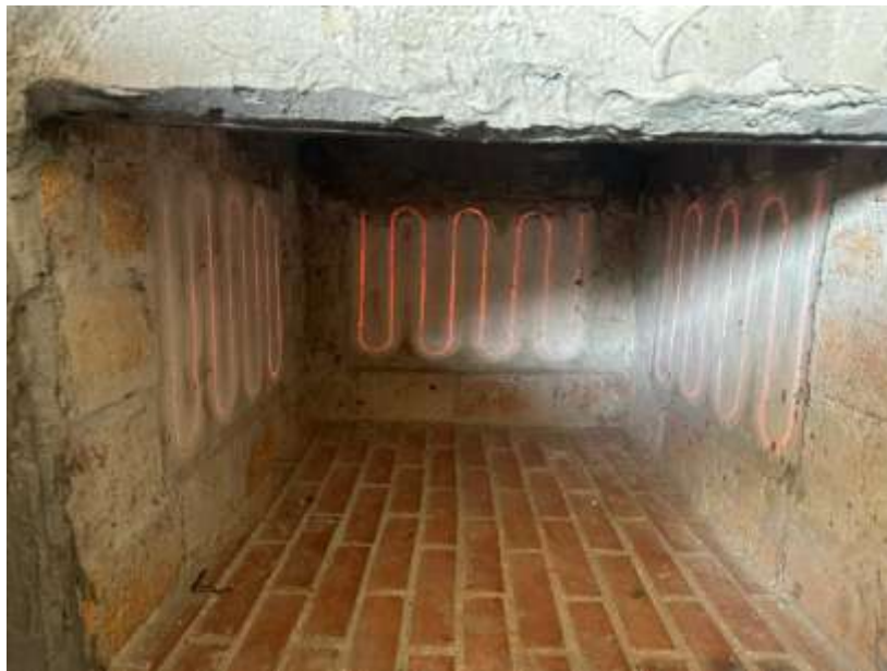
Figura 45. Transferencia de calor a través de resistencias uniformemente accionadas.
